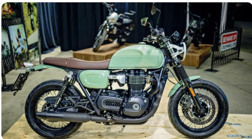
wie T120), Markenkomponenten von Nissin (Bremsen), Kayaba (Federelemente) und Bosch (ABS), zwei Fahrmodi (ECO und Sport), LED-Tagfahrlicht und -Blinker, Traktionskontrolle – die Zutaten überzeugen. Auch die Verarbeitung scheint zu stimmen, soweit das erste Fotos ohne Markenembleme erkennen lassen. Das runde kleine TFT-Display hingegen wirkt überladen und verspielt.
