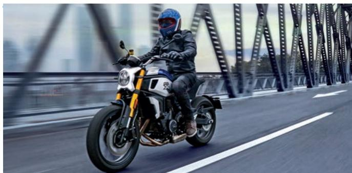
Moto mit einem Vorderreifen in der Dimension 110/80-18. Auf den zweiten Blick wirkt nicht nur die Gabel recht einfach gestrickt, der Verzicht auf eine Doppelscheibenbremse am Vorderrad deutet ebenfalls den Sparkurs beim Entwurf der 700CL-X an. Immerhin misst die Einzelscheibe 320 Millimeter und wird von einem Bosch-ABS unterstützt.
