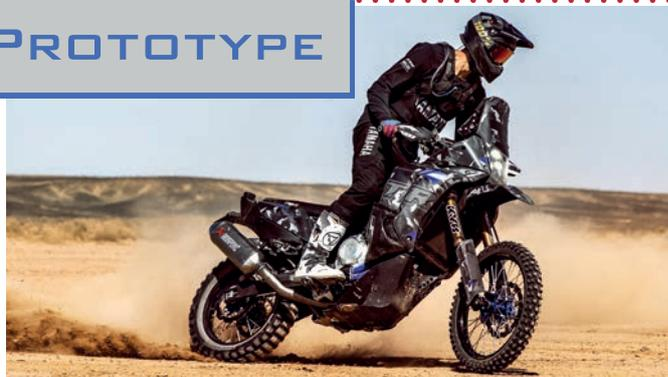
derbein hinten mit 260 mm Federweg und neuer Umlenkung an der Hinterradschwinge. 300er-Bremsscheibe vorn, 267er hinten, Kettenrad mit 48 statt 46 Zähnen. Akrapovic-Komplettauspuff aus Titan. Größerer Wasserkühler mit Zusatzlüftern. Gut so, Yamaha. Mal schauen, wann die Raid-Variante kommt. **RB**
